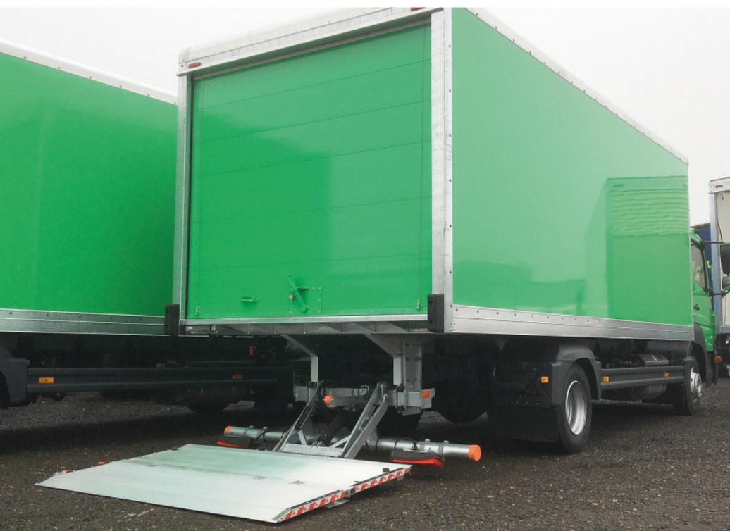
La DH-RP.10 es el modelo mediano de plataforma de 3 brazos dentro de una joven generación de **de plataformas replegables** de peso ligero pero muy fuertes con un **recorrido de plato progresivo** desde el piso del vehículo hasta el suelo.
