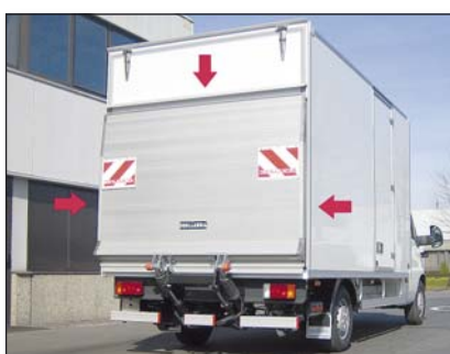
S610 Anodización del plato en aluminio
