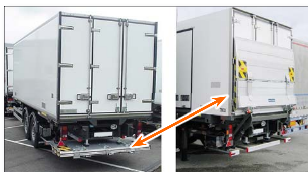
DH-SM 1500-2000 kg y opción S244 - Plataforma retractable con facilidad de cierre del plato en posición vertical
