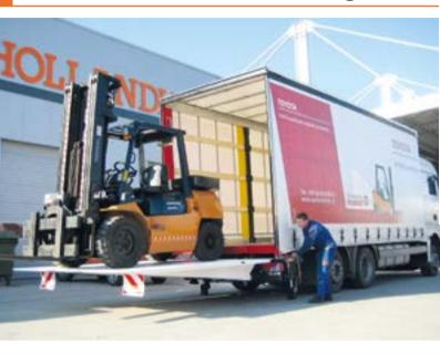
La robusta plataforma DH-LSU.60 está diseñada para levantar **capacidades extremas de 4000 a 6000 kg** y se emplea, principalmente, para el transporte de maquinaria pesada, toros, tractores etc.
